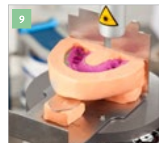
DIVARIO® Abdruckträger L inklusive DIVARIO® Plattenaufnahme Duo auf die Magnetplatte des DIVARIO® Pinbohrgerätes M23 compact setzen.
