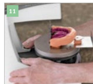
Bohrvorgang durch Knopfdruck starten, die DIVARIO® Plattenaufnahme Duo wird elektromagnetisch fixiert.
