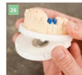
DIVARIO® Splitcastplatte vor dem Einartikulieren aufsetzen, um eine exakte Passung zu garantieren.
